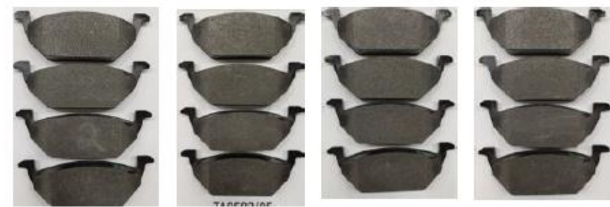
Fig. 2. Aparência visual das pastilhas de freio produzidas utilizando resíduo de usinagem nas concentrações: a) 4,76%, b) 9,52%, c) 19,04% e d) 28,56%.
